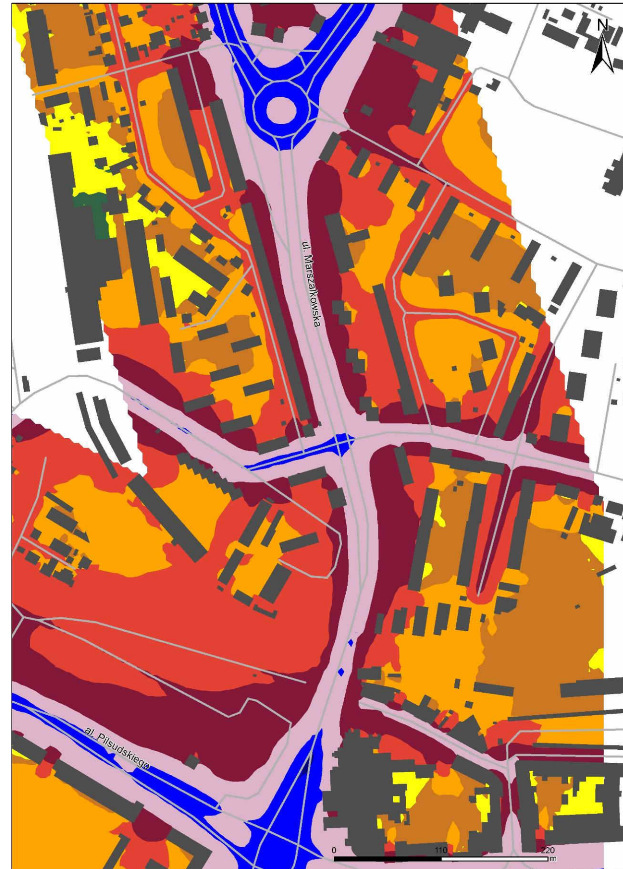
Mapa emisji dźwięku przed i po zastosowaniu działań naprawczych zaproponowanych w Programie dla ul. Marszałkowskiej na odcinku od ronda Jana Pawła II do wiaduktu kolejowego – wskaźnik L_{DWN}
