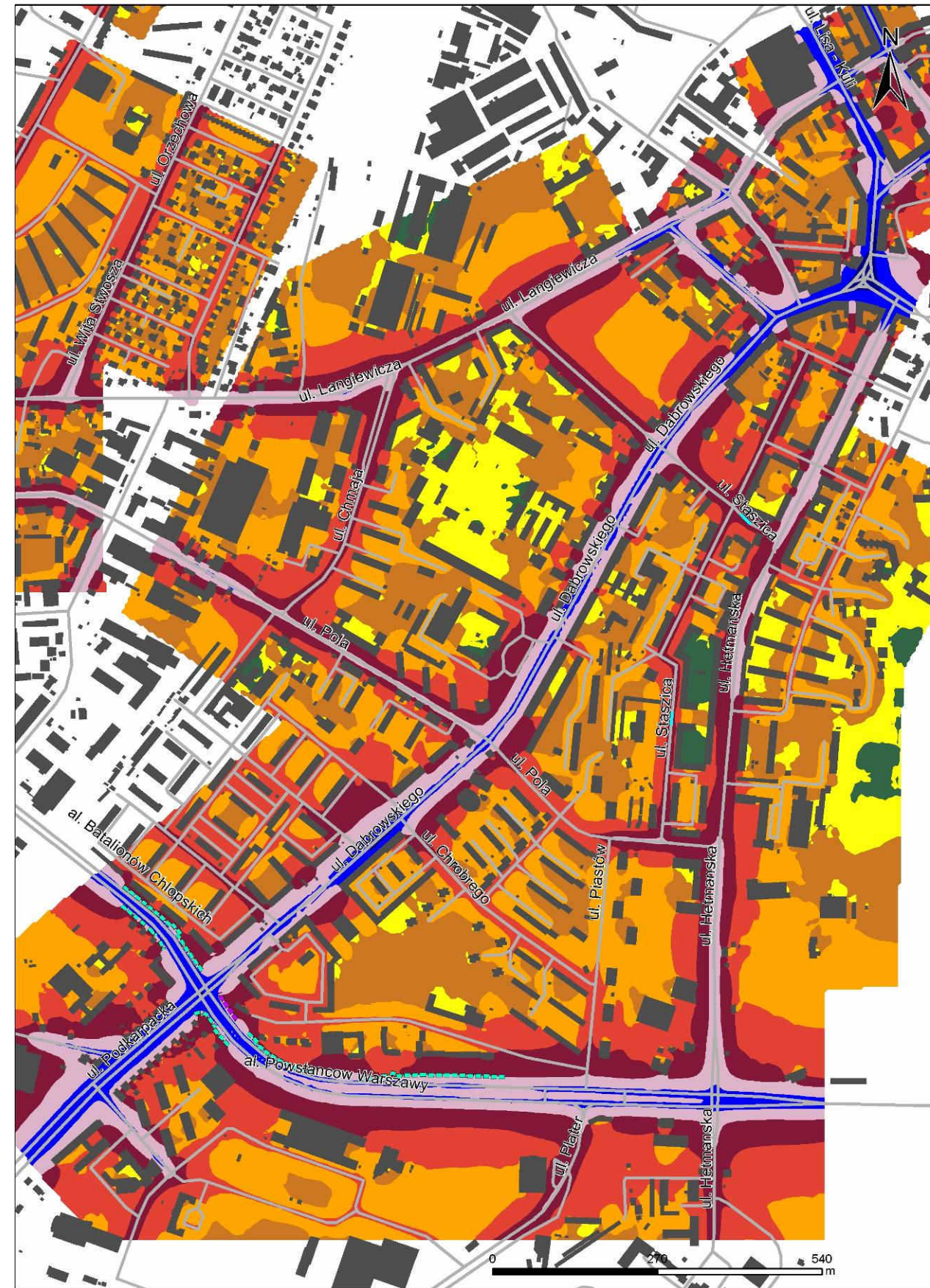
Mapa emisji dźwięku przed i po zastosowaniu działań naprawczych zaproponowanych w Programie dla ul. Gen. Jarosława Dąbrowskiego na odcinku od Trasy Zamkowej do al. Batalionów Chłopskich – wskaźnik L_{DWN}
