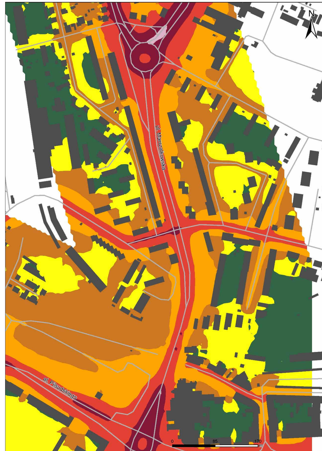
Mapa emisji dźwięku przed i po zastosowaniu działań naprawczych zaproponowanych w Programie dla ul. Marszałkowskiej na odcinku od ronda Jana Pawła II do wiaduktu kolejowego – wskaźnik L_N
