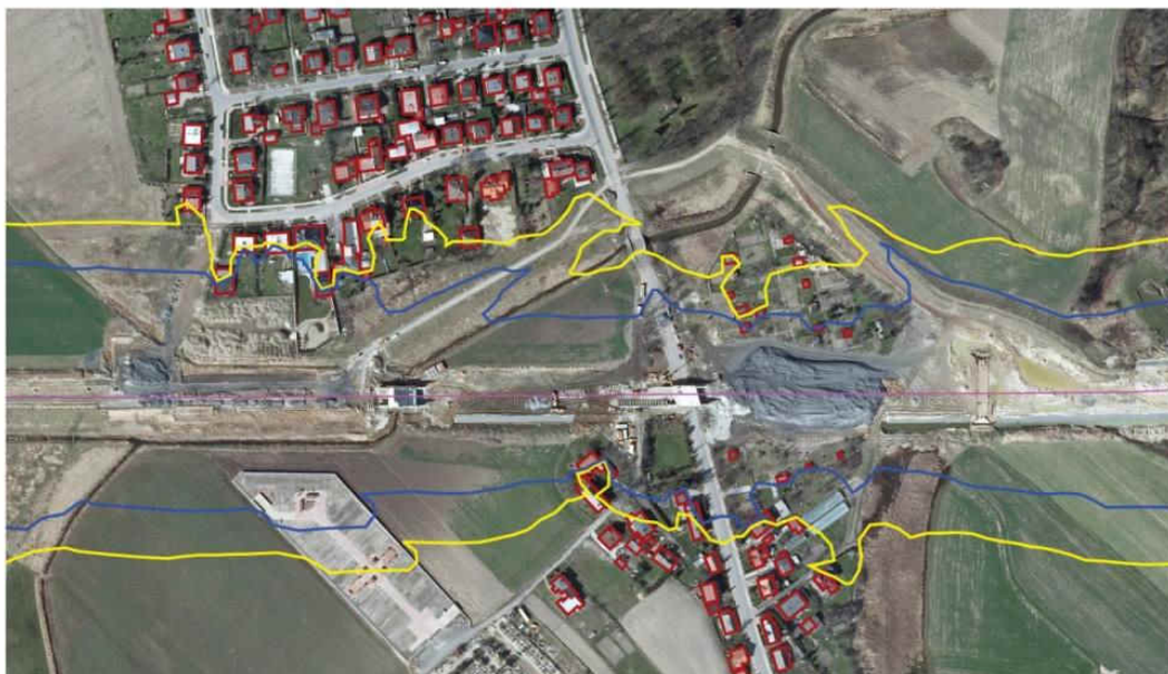
Rys. 3.1. Oddziaływanie akustyczne wybranego odcinka drogi przy zastosowaniu wskaźników L_{AeqD} i L_{AeqN}
