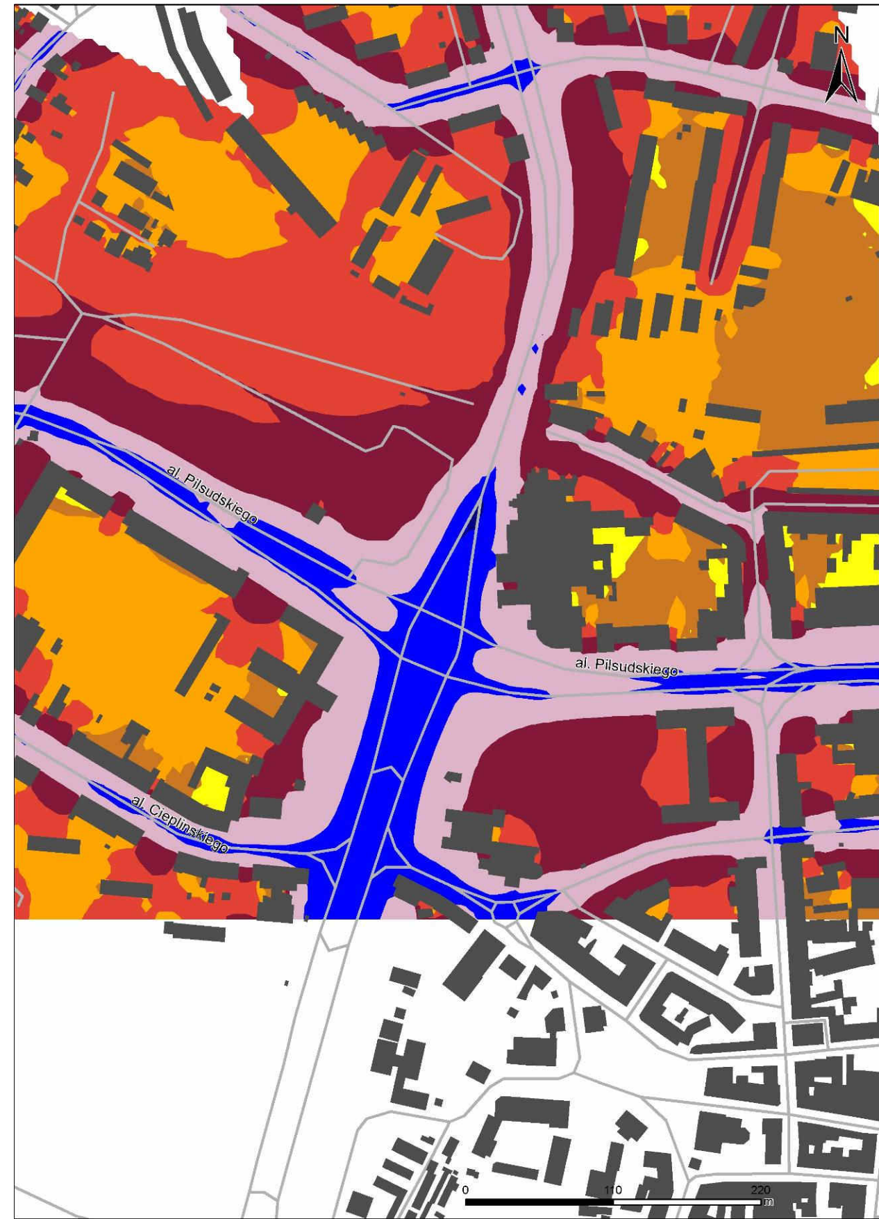
Mapa emisji dźwięku przed i po zastosowaniu działań naprawczych zaproponowanych w Programie dla al. Marszałka Piłsudskiego od mostu Lwowskiego do ul. Targowej – wskaźnik L_{DWN}
