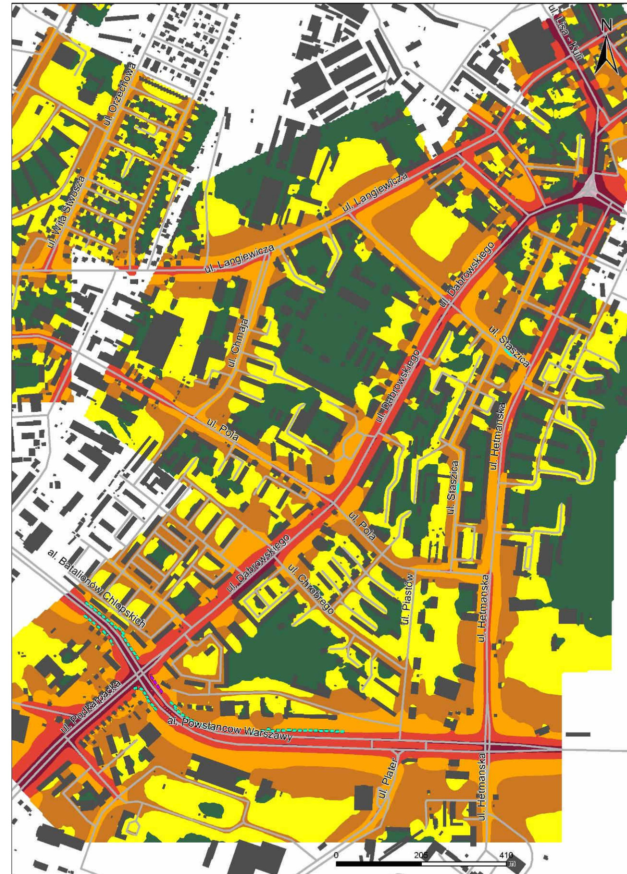
Mapa emisji dźwięku przed i po zastosowaniu działań naprawczych zaproponowanych w Programie dla ul. Gen. Jarosława Dąbrowskiego na odcinku od Trasy Zamkowej do al. Batalionów Chłopskich – wskaźnik L_{\text{N}}
