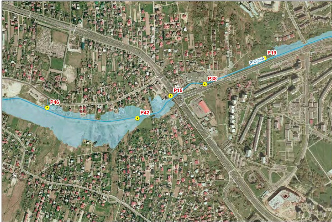
Ryc. 116. Lokalizacja wylotów kanalizacji deszczowej do potoku Przyrwa
