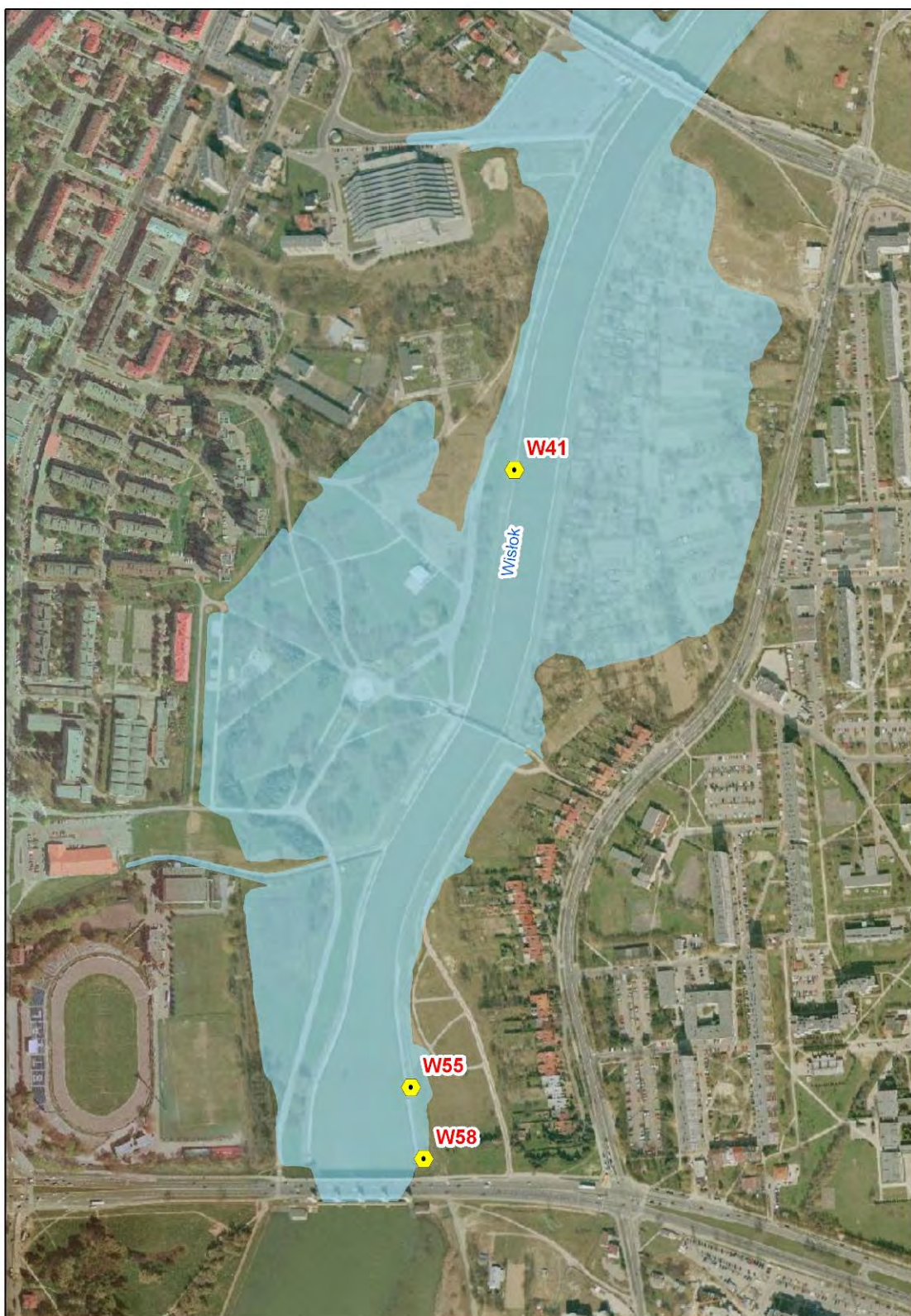
Ryc. 138. Lokalizacja wylotów kanalizacji deszczowej do Wisłoka - cz. 1
