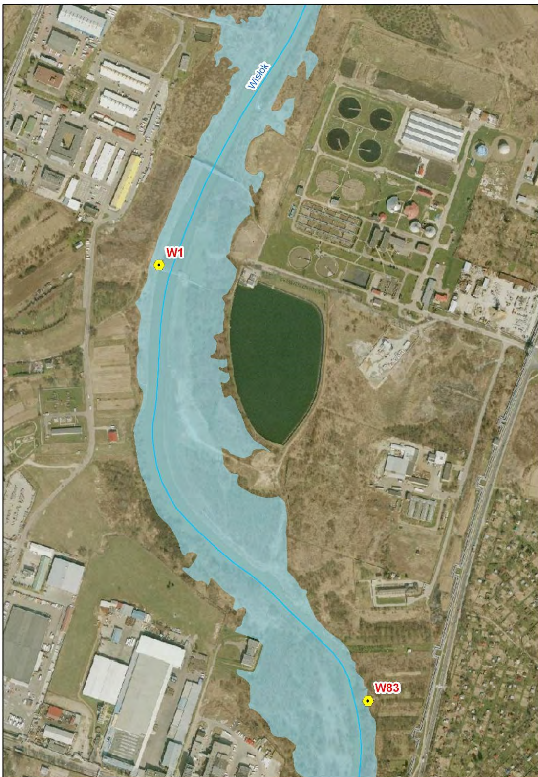
Ryc. 142. Lokalizacja wylotów kanalizacji deszczowej do Wisłoka - cz. 3
