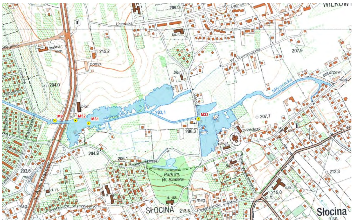
Ryc. 129. Lokalizacja wylotów kanalizacji deszczowej do potoku Młynówka
