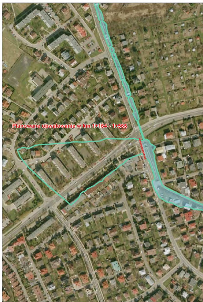
Ryc. 126. Lokalizacja planowanego wału na lewym brzegu Młynówki
