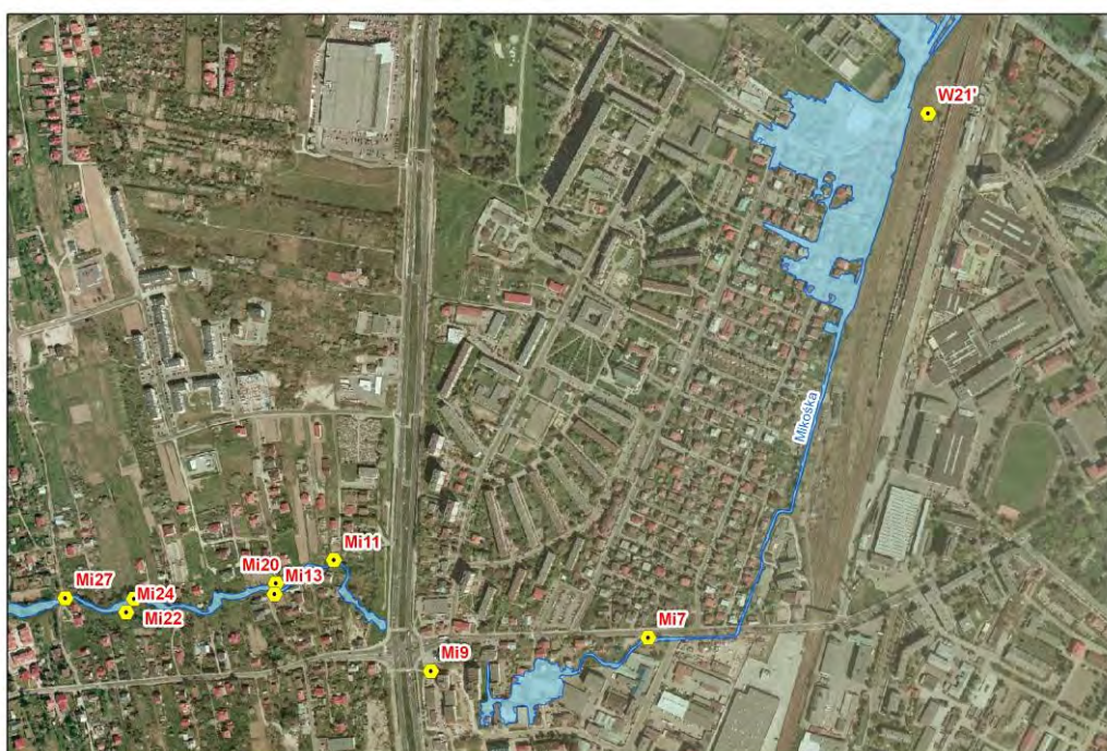
Ryc. 122. Lokalizacja wylotów kanalizacji deszczowej do potoku Mikośka - cz. 2
