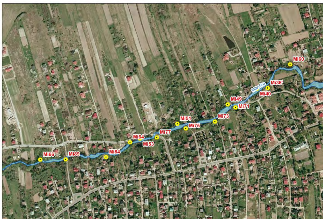
Ryc. 120. Lokalizacja wylotów kanalizacji deszczowej do potoku Mikośka - cz. 1
