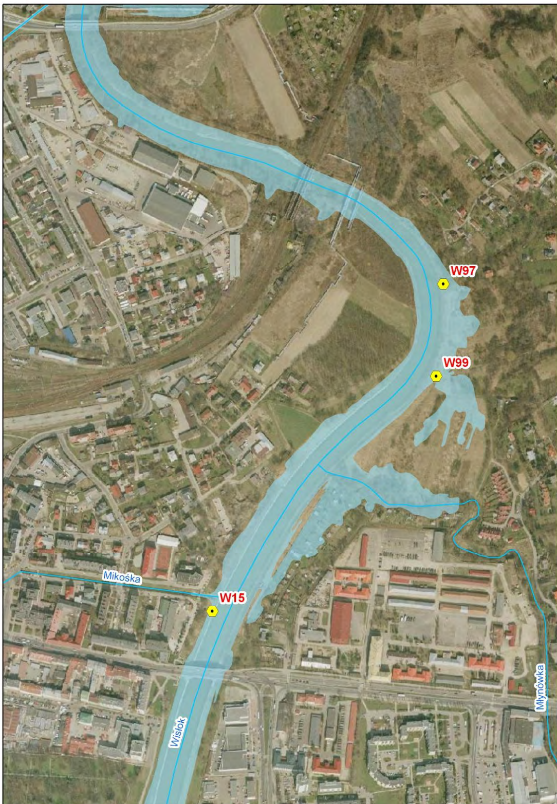
Ryc. 140. Lokalizacja wylotów kanalizacji deszczowej do Wisłoka - cz. 2
